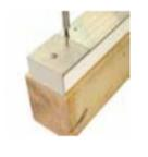
Profiloberteile im Abstand von 40 cm mittig vorbohren ( $\varnothing$  7 mm). Der Abstand der ersten Bohrung zur vorderen Kante beträgt 6 cm.
