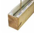
Profilunterteile im Abstand von 35 cm links und rechts vom Mittelsteg im Wechsel vorbohren ( $\varnothing$  5 mm). Der Abstand der ersten Bohrung zur vorderen Kante beträgt 8 cm.
