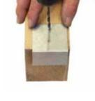
Bohren Sie den Abschluss- und Haltewinkel mit einem Bohrdurchmesser von 5 mm vor. Abstände zur Biegekante 20 und 45 mm.
