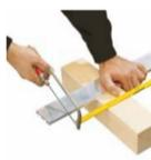
Ermitteln Sie die genaue Endlänge der Profile. Falls erforderlich mit einer Metallsäge kürzen.
