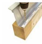
Bohren Sie den Alu-Wandanschluss. Der Bohrdurchmesser richtet sich nach den verwendeten Schrauben. Die erste Bohrung erfolgt nach ca. 5 cm, die folgenden Bohrungen immer in einem Abstand von ca. 40 cm.
